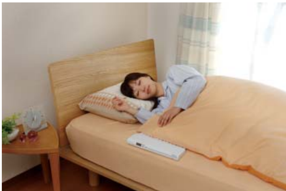
スリープスキャンを使った睡眠計測のイメージ 実際に計測する際にはセンサーマットは寝具の下に敷きます。
